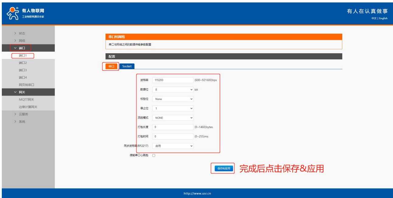
图 5 端口 1 串口参数配置
