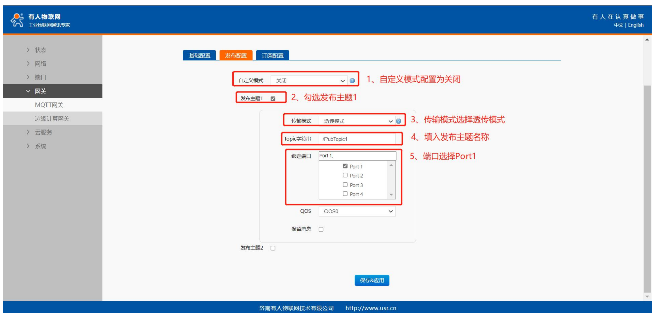
图 2 MQTT 发布配置
