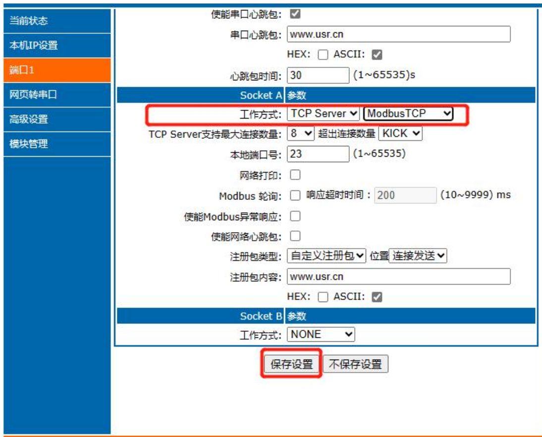
图 51 Modbus RTU 转 Modbus TCP
