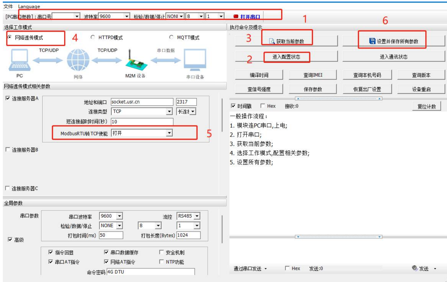
图 5. Modbus RTU 转 Modbus TCP
